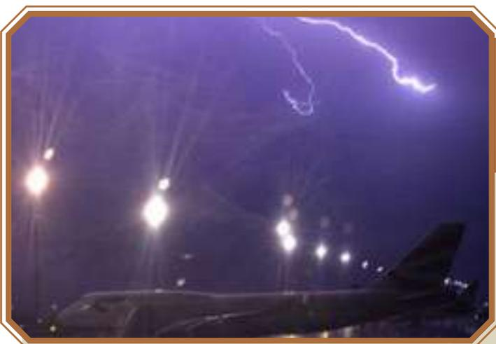
El fuselaje metálico de un avión es, efectivamente, una Jaula de Faraday (efecto por el cual el campo electromagnético dentro de un conductor
